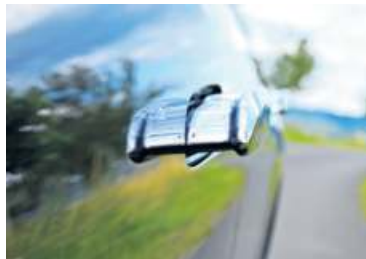
Die automatisch ausfahrenden Türgriffe haken schon mal.
