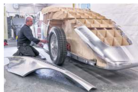
Da steckt nur Handarbeit drin: Bleche werden über Holz gedengelt. Foto: dpa-tmn/Stefan Warter
